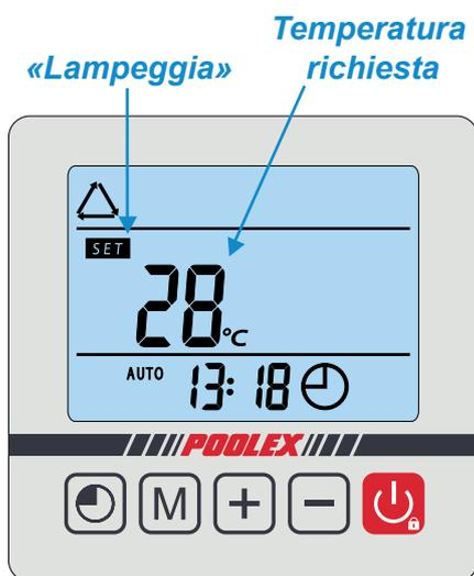
Quando il simbolo smette di lampeggiare, la temperatura richiesta viene registrata e sostituita dalla temperatura attuale dell'acqua (nel nostro esempio, 25°).
