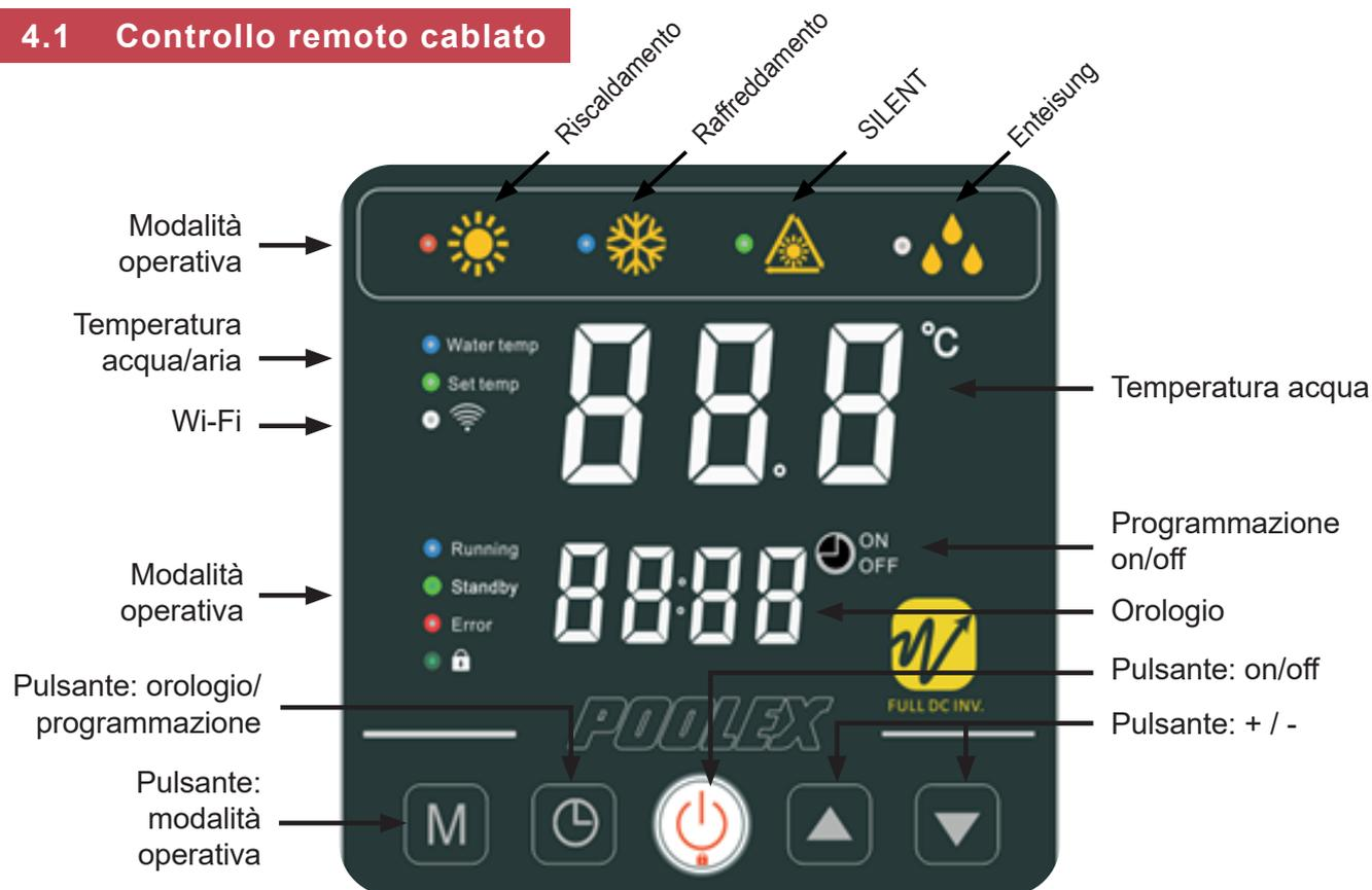
Il controllo remoto torna automaticamente alla schermata principale dopo 10 secondi.
