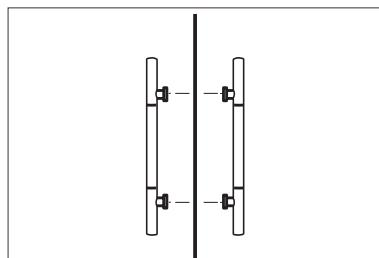
En el exterior de la puerta, coloque la manija en línea con los orificios provistos.
