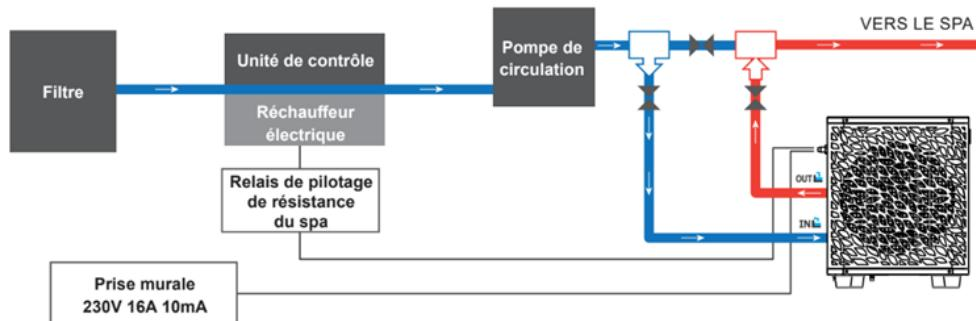
Remarque : Installez votre pompe à chaleur à la sortie de la pompe de filtration pour que le capteur de débit fonctionne. Le capteur de débit sert à la sécurité du flux d'eau. S'il ne fonctionne pas, la pompe à chaleur ne se mettra pas en route.
