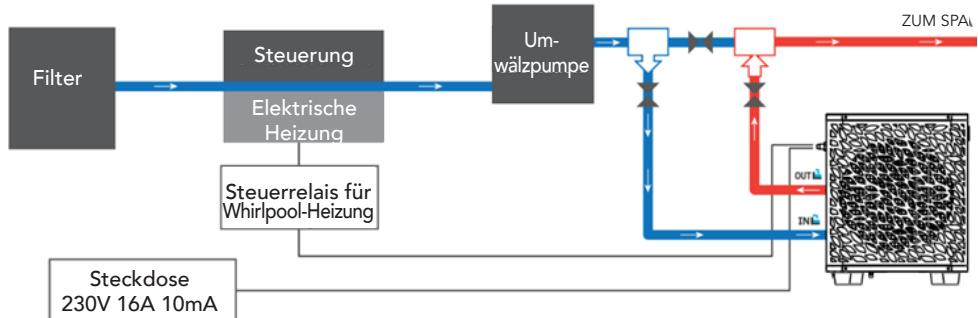
Hinweis: Installieren Sie Ihre Wärmepumpe am Auslass der Filterpumpe, damit der Durchflusssensor funktioniert. Der Durchflusssensor dient der Sicherheit des Wasserflusses. Wenn er nicht funktioniert, schaltet sich die Wärmepumpe nicht ein.
