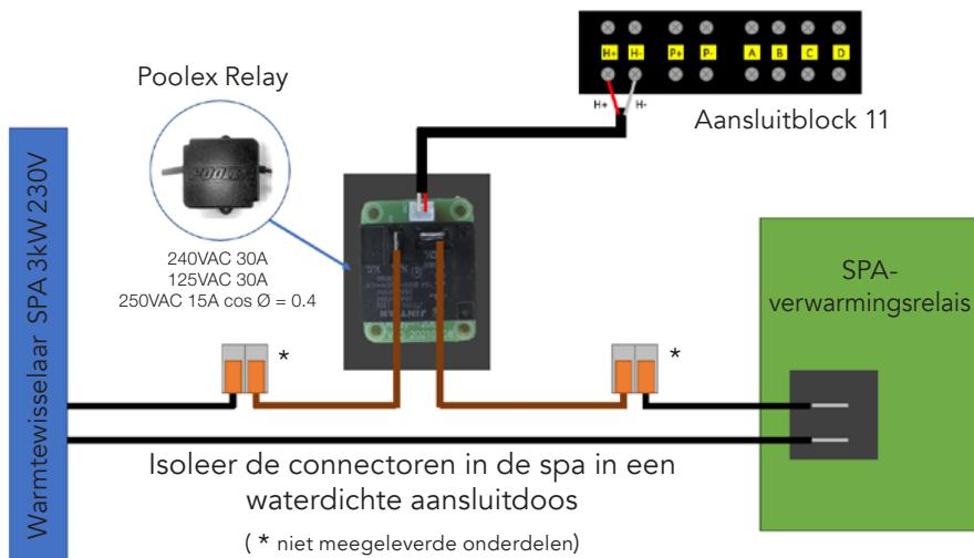
Het SPA-verwarmer-SPAWER-stuursysteem bestaat uit een vermogensrelais (230V50Hz / 30A) dat wordt aangesloten op de fasedraad van de verwarmers (tussen de uitgang van de SPAverwarmercontroller en de verwarmers zelf).
