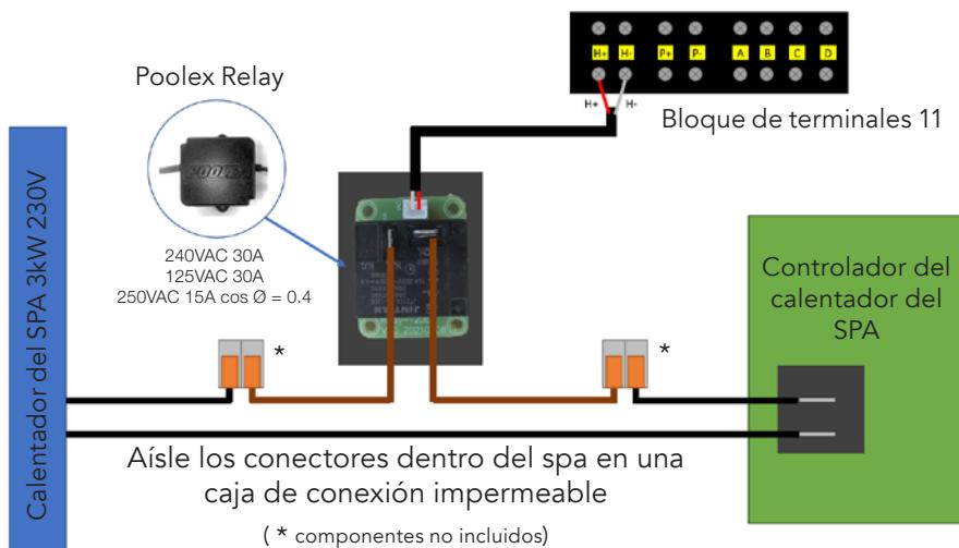
El sistema controlador SPAWER del calentador SPA consta de un relé de alimentación (230 V, 50 Hz/30 A) que se conecta al cable de fase del calentador (entre la salida del controlador del calentador SPA y el calentador mismo).
