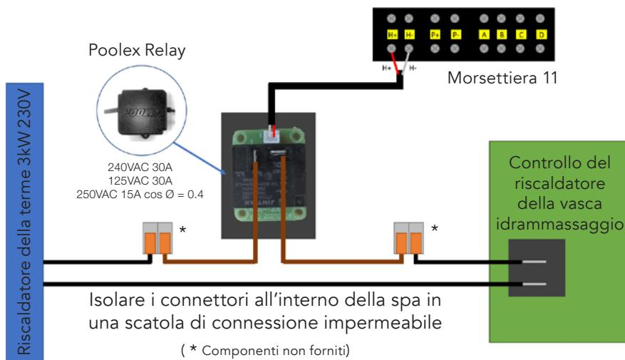
Il sistema di controllo SPAWER del riscaldatore della VASCA IDRAMMASSAGGIO è costituito da un relè di potenza (230V50Hz / 30A) che si collega al cavo di fase del riscaldatore (tra l'uscita del controller del riscaldatore della vasca idromassaggio e il riscaldatore stesso).
