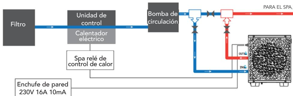
Nota: Instale la bomba de calor en la salida de la bomba del filtro para que funcione el sensor de caudal. El sensor de caudal se utiliza para garantizar un caudal de agua seguro. Si no funciona, la bomba de calor no se encenderá.
