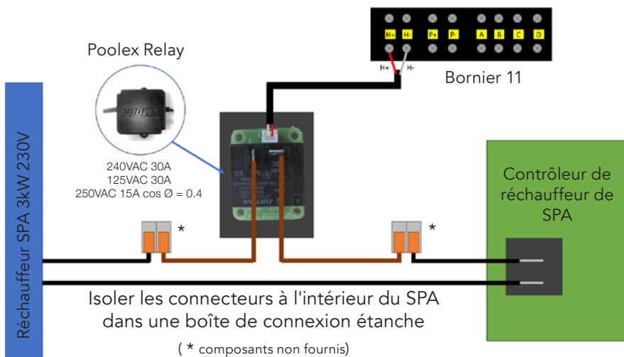
Le système de pilotage SPAWER du réchauffeur de SPA est composé d'un relais de puissance (230V50Hz/30A) qui se branche sur un fil de phase du réchauffeur (entre la sortie du contrôleur du réchauffeur du SPA et le réchauffeur lui-même).
