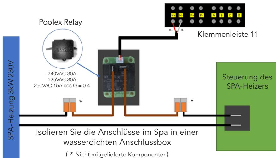
Das SPAWER-Treibersystem der SPA-Heizung besteht aus einem Leistungsrelais (230 V, 50 Hz / 30 A), das in das Heizphasenkabel (zwischen dem Ausgang des SPA-Heizungsreglers und der Heizung selbst) eingesteckt wird.
