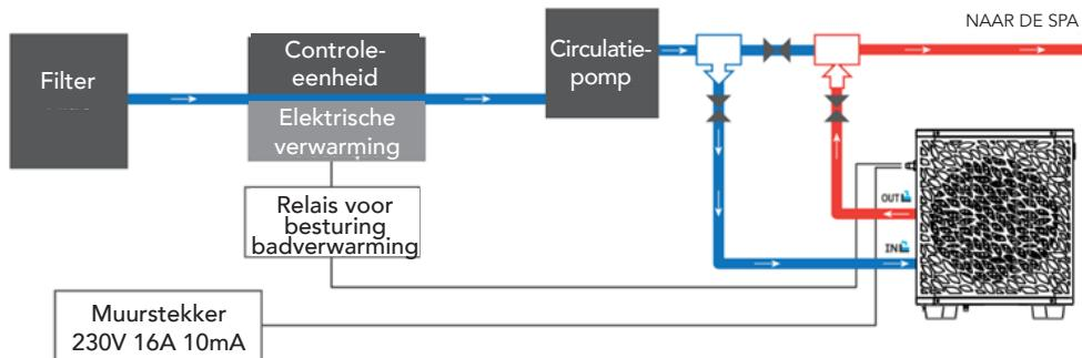
Opmerking: Installeer je warmtepomp bij de uitlaat van de filterpomp zodat de stromingssensor werkt. De stromingssensor wordt gebruikt om een veilige waterstroom te garanderen. Als hij niet werkt, zal de warmtepomp niet opstarten.
