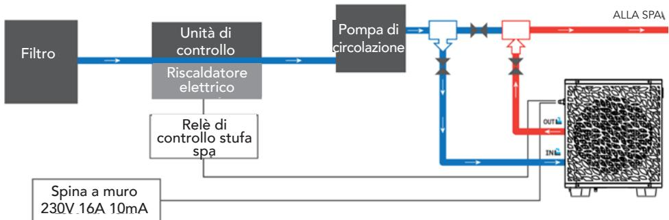
Nota: installare la pompa di calore all'uscita della pompa filtro in modo che il sensore di flusso funzioni. Il sensore di flusso serve a garantire un flusso d'acqua sicuro. Se non funziona, la pompa di calore non si avvia.
