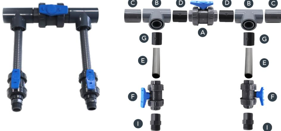
**Optie 2:** De bypass-kit moet rechtstreeks in de spa worden geïnstalleerd met Ø32mm-kleppen. De lengte van flexibele PVC E moet worden bepaald aan de hand van de positie van de warmtepomp ten opzichte van de spa.
